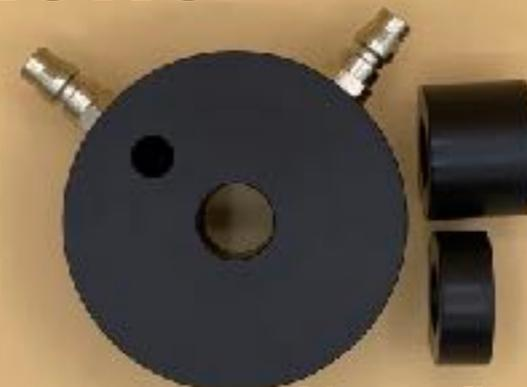
Adattatore per scambiatore di calore cambi Aisin
